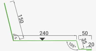
**WANDANSCHLUSS HINTERLÜFTET, FÜR KLEMMLEISTE 150/225**
