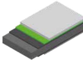
■ Decklack ■ Stahl ■ Zinkschicht
