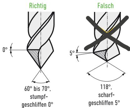
**Bohrlochgröße:** Der Ausdehnungskoeffizient von PVC-hart beträgt 0,8 mm/m/10K Temperaturunterschied. Um die materialbedingte Ausdehnung der Rhenoplast®-Lichtplatten zu berücksichtigen, sind je nach Plattenlänge entsprechend große Bohrlöcher in den Lichtplatten vorzubohren.
