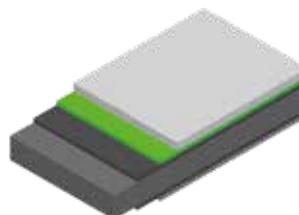
■ Decklack ■ Stahl ■ Zinkschicht
