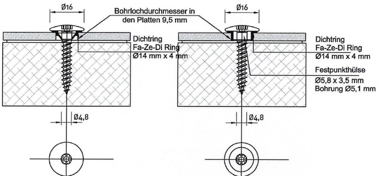
Dichtring Fa-Ze-Di Ø14 mm x 4 mm
