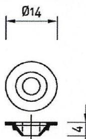
Festpunkthülse Ø8,5 x 3,5 mm - Bohrung Ø5,1 mm
