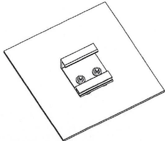
3. Neben der optischen Kontrolle ist der korrekte Einbau der Agraffen durch Einführen der Messlehre zu kontrollieren.
