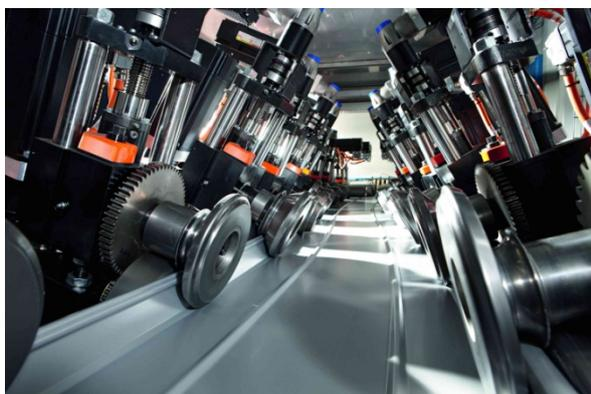
Bild 1: Profiliervorgang am Beispiel eines Falzprofils
